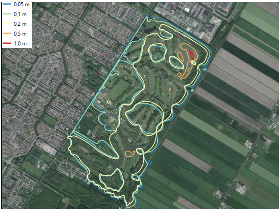
Figuur 26: Effect verhogen oppervlaktewaterpeil op grondwaterstand in de Golfbaan.
